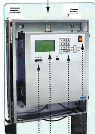
メモリーカード挿入口 操作ボタン 表示器(LCD) 電源スイッチ
